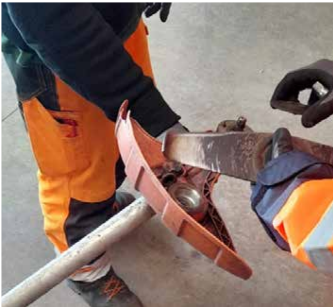
📷 Changement têtes débroussailleuse
